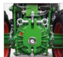
Agria-Anbauflansch: einfacher und schneller Anbaugerätewechsel
