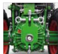
Agria-Anbauflansch: einfacher und schneller Anbaugerätewechsel
