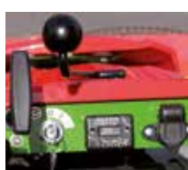
Praktische Armaturentafel mit Betriebsstundenzähler, Drehzahlmesser, Zündschloss und 12 V-Steckdose
