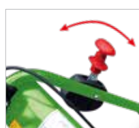
Stufenloser Vario- antrieb (nur premium)
