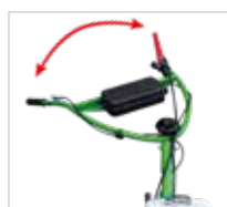
Lenkholm werkzeuglos seitenerstellbar
