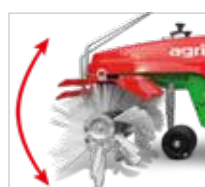
Flexibles Einstellen des Bürstendrucks
