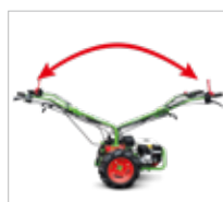
Lenkholm um 180° drehbar
