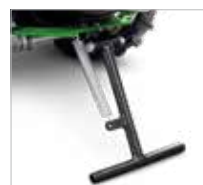
Stützfuß erleichtert das Abstellen der Maschine
