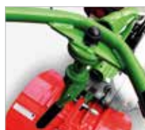
Werkzeuglose Seitenverstellung des Lenkholms mit Schnelleinstellhebel
