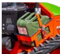
Agria-Wechseltanksystem, Füllstandsanzeige auf Fernbedienung
