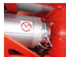
Sicherheit am Hang dank elektromechanischer Bremse
