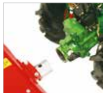
Rohrbaufansch: einfacher und schneller Anbaugerätewechsel
