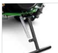
Stützfuß erleichtert das Abstellen der Maschine
