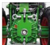
agria-Anbauflansch: einfacher und schneller Anbaugerätewechsel
