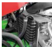
Zusätzlicher Ölkühler für den Einsatz auch bei großer Hitze
