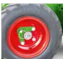
Radmitnehmer: wahlweise Einzelrad- oder Zweiradantrieb
