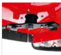
Robuste und vor Widerständen ausweichende Pendelmesser
