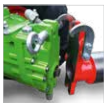
Agria-Anbauflansch: einfacher und schneller Anbaugerätewechsel
