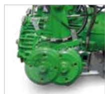
Portalachse zur Schwerpunktverstellung
