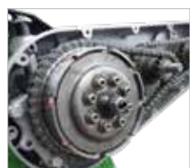
Robustes und langlebiges Kettengetriebe im Ölbad
