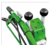
Steuerung der Fahrtrichtung mit Wendeschaltung am Lenkholm
