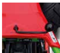
Sicheres Abstellen der Maschine mit zentraler Feststellbremse
