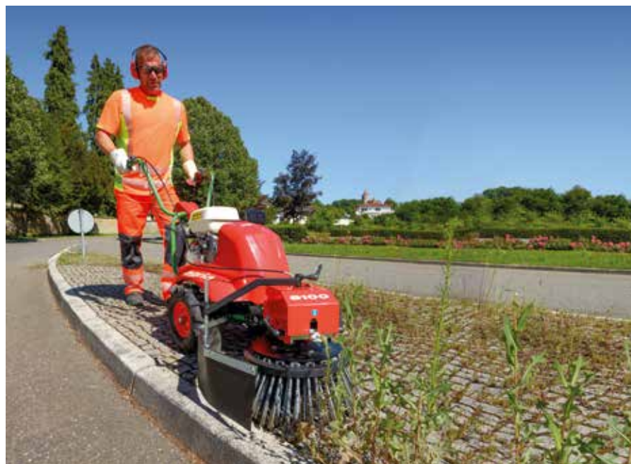
Flachdrahtbürste für normal verunkrautete Strukturflächen
