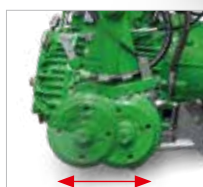
Portalachse zur Schwerpunktverstellung
