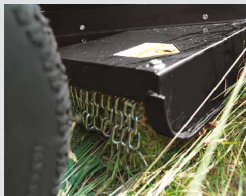
Ein Kettenvorhang an der Vorder- und Rückseite verhindert, dass langes Gras plattgedrückt wird und nicht richtig gemäht werden kann.
